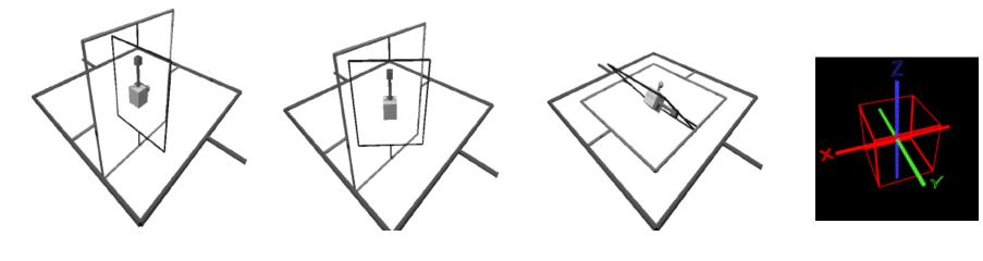
$$R(\alpha, \frac{\pi}{2}, \gamma) = \begin{pmatrix} 0 & \cos\gamma\sin\alpha - \cos\alpha\sin\gamma & \cos\alpha\cos\gamma + \sin\alpha\sin\gamma & 0\\ 0 & \cos\alpha\cos\gamma + \sin\alpha\sin\gamma & \cos\alpha\sin\gamma - \cos\gamma\sin\alpha & 0\\ -1 & 0 & 0 & 0\\ 0 & 0 & 0 & 1 \end{pmatrix}$$
